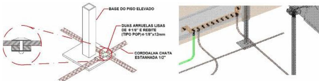
Figura 03 – Detalhe do sistema de aterramento com malha de aterramento
